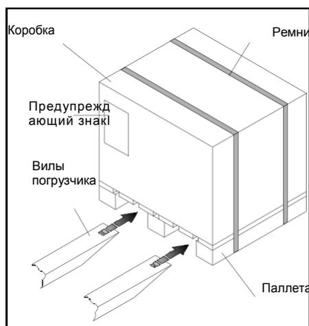
РИС.4 (Положение вил погрузчика)
