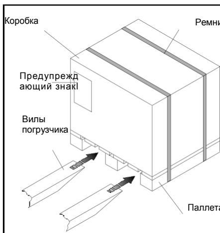
**РИС.4 (Положение вил погрузчика)**
