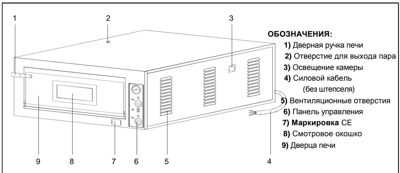
РИС.2 (Обозначение компонентов)
