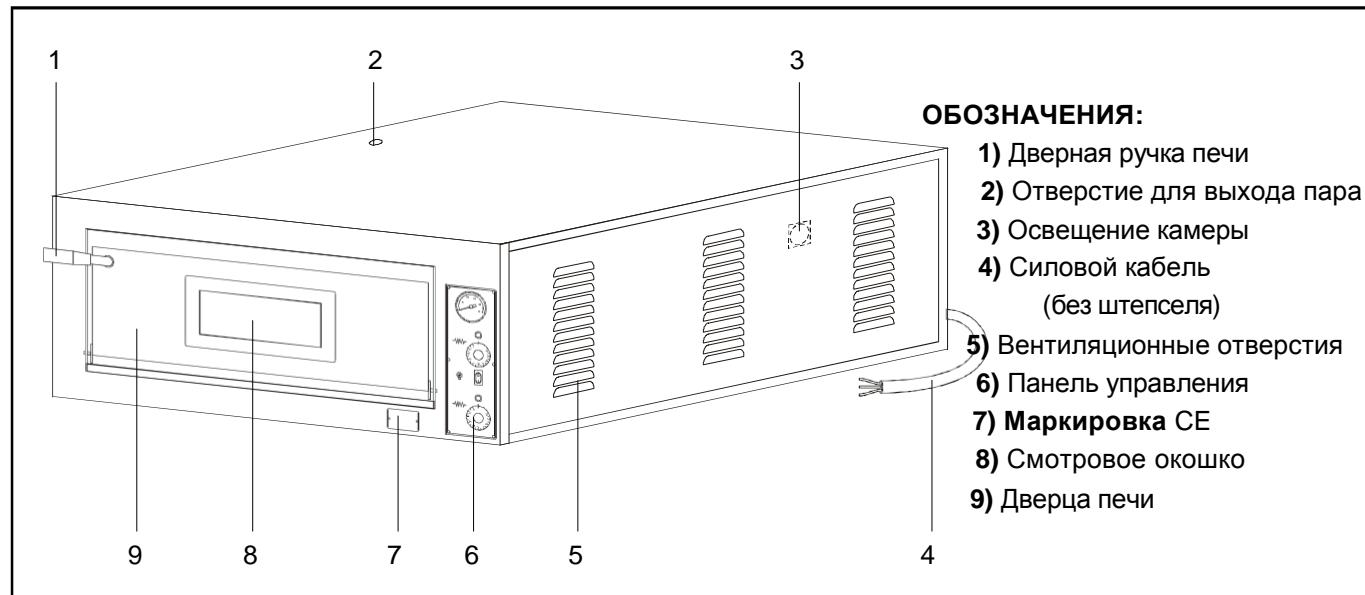
РИС.2 (Обозначение компонентов)
