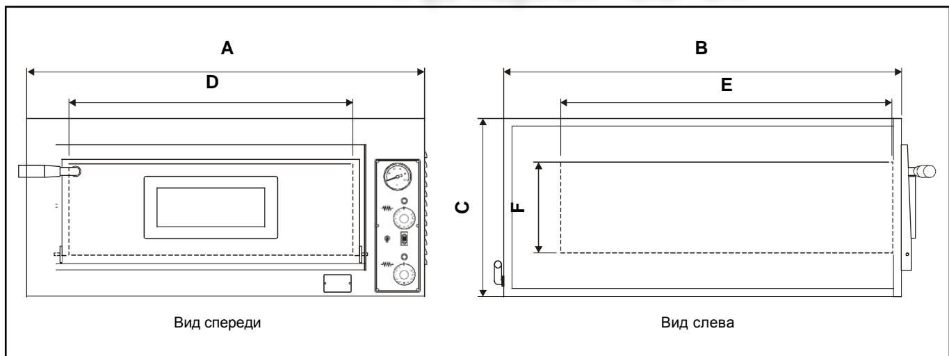
РИС.3 (Габариты печи и пекарной камеры)
