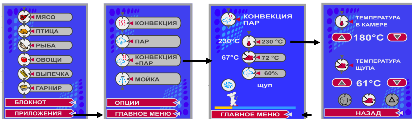
Рисунок 10. Переходы экрана для незапрограммированного режима работы пароконвектомата.
