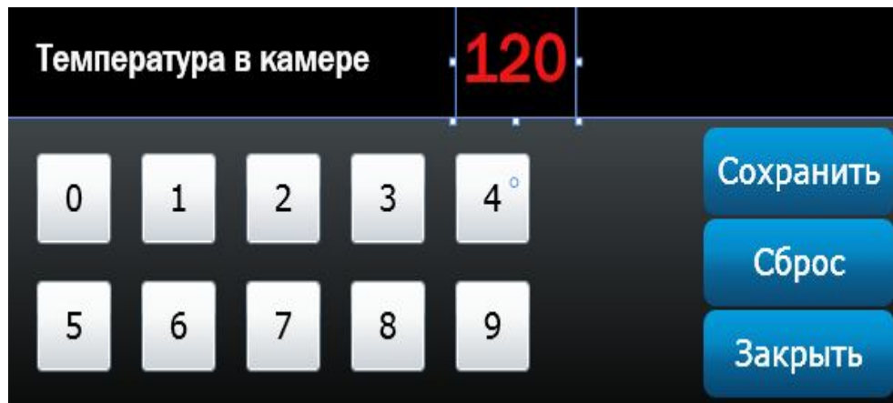
Рис. 9. Экран редактирования параметра «Температура в духовке»
