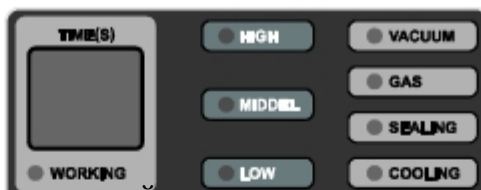
Рисунок 4.3 - Расположение таймера и индикаторов панели управления
