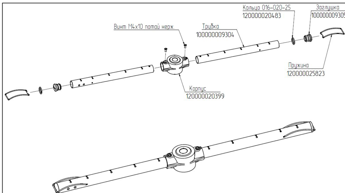
Рис.2. Моющий разбрызгиватель нового образца (код 1С – 100000009787)
