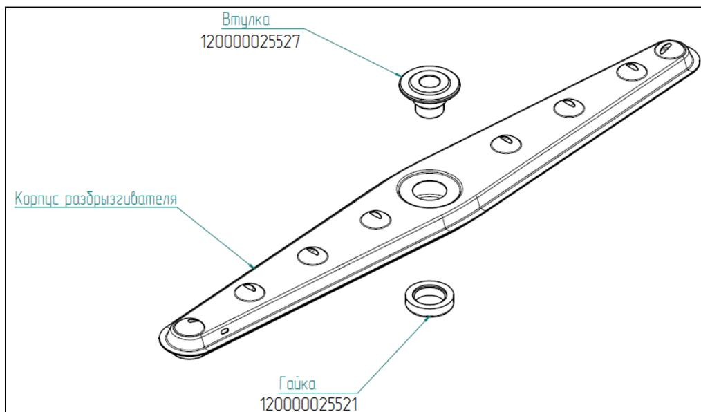
Рис.1. Моющий разбрызгиватель старого образца (код 1С – 100000005478)
