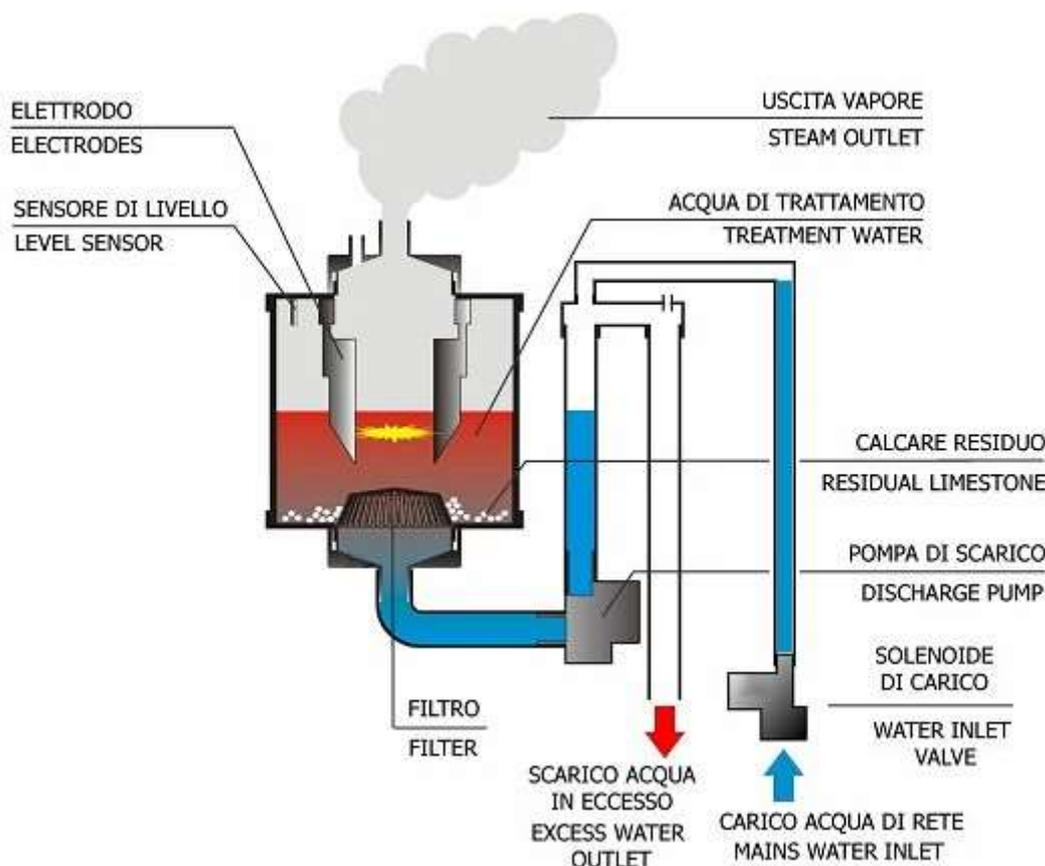
Il vapore erogato è gestito in maniera proporzionale alla richiesta di produzione vapore che il controllo elettronico calcola in base al funzionamento scelto tra gli otto disponibili descritti nel cap.
