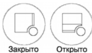
Рис.4. Положения фиксаторов защитной решетки вентилятора
