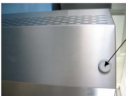
Schalter / switch, Teile-Nr. 3124268 (inkl. Glühlampe/lamp)
