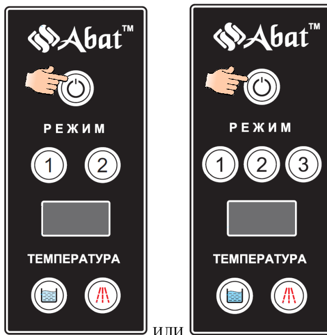
Рис. 3 Вход в настройки контроллера
