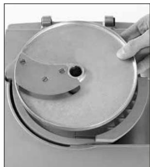
Установите затем соответствующий диск-измельчитель и прокрутите его в направлении часовой стрелки, чтобы проверить правильность его установки.
