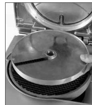
Установите затем соответствующий диск-мельчитель (диск с прямым ножом) и прокрутите его в направлении часовой стрелки, чтобы проверить правильность его установки.
