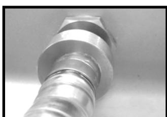
2. Присоедините шланг к отверстию вакуумирования внутри вакуумной камеры.
