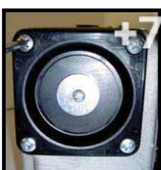
Снимите крышку камеры воздушного фильтра
