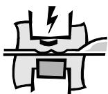
Система запайки серии JUMBO оборудована двумя запаечными струнами шириной 3,5 мм каждая.
