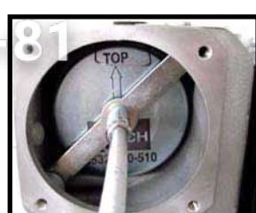
Снимите прижимную пластину
