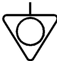
Рисунок 3- Знак эквипотенциального заземления
