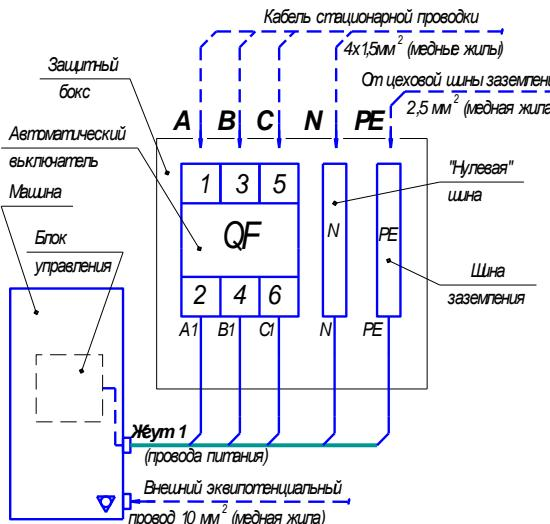
Рисунок 6 - Схема электрическая подключения
