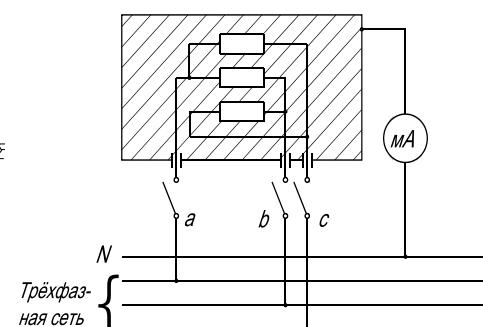
Рисунок 4 – Схема измерения тока утечки
