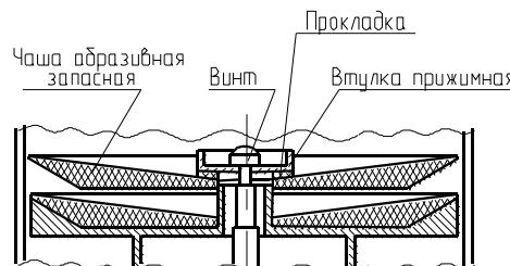
Рисунок 3 – Схема крепления чаши запасной абразивной
