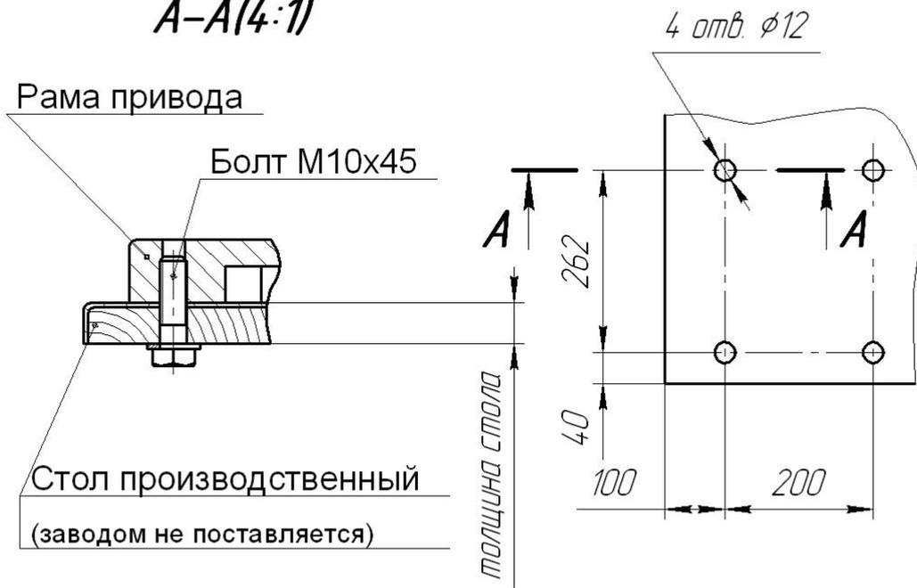
Рисунок 8 – Схема установки привода на столе
